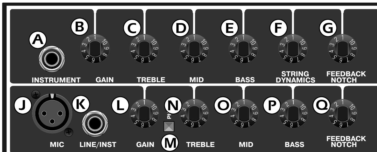
A. Разъем INSTRUMENT — Служит для подключения гитары или акустического инструмента.
