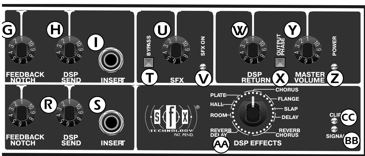
R. Регулятор DSP SEND — Устанавливает уровень сигнала отбора из микрофонного/линейного канала Acoustasonic SFX на встроенный эффект-процессор.
