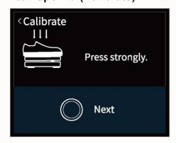
Затем с усилием нажмите на всю педаль до упора вниз и нажмите на регулятор PARA, чтобы перейти на следующий экран (Next).
