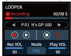
Одновременно нажмите на ножные переключатели [+]/[-], чтобы открыть меню зацикливания (LOOPER). Во время записи и наложения индикатор состояния в верхней части экрана отобразится красным, а в режиме исполнения индикатор будет подсвечен голубым.
