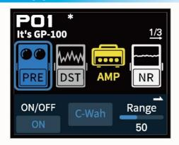
Поверните регулятор PARA или нажмите на ножной переключатель, чтобы переключить патч. Нажмите на регулятор PARA или на кнопку EDIT, чтобы войти в режим редактирования. В меню режима редактирования отобразятся 10 иконок для девяти эффектов GP-100.
