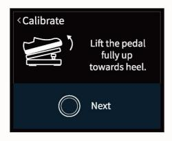
Поднимите педаль до упора вверх и нажмите на регулятор PARA, чтобы перейти на следующий экран (Next).
