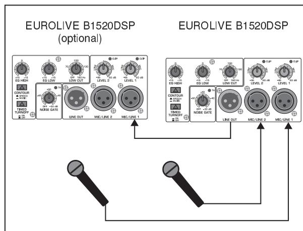
Рис. 3.1: Подключение микрофонов
