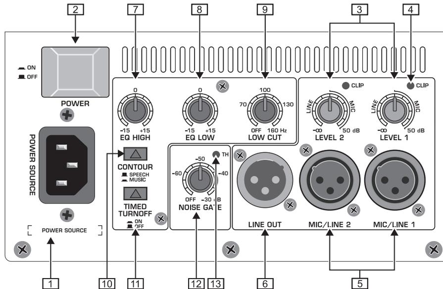
Рис. 2.1: Обратная сторона, элементы управления и разъемы
