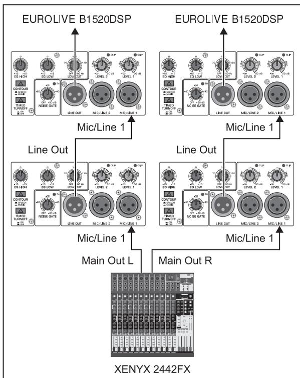
Рис. 3.3: Соединение нескольких B1520DSP
