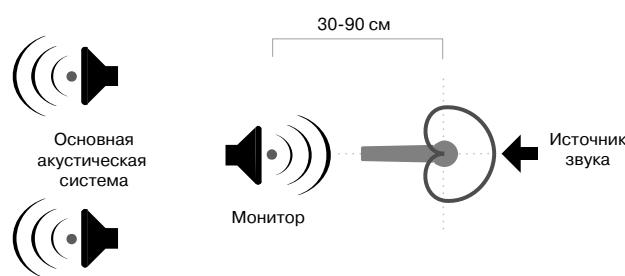
2. Располагайте микрофон на максимальном расстоянии от отражающих поверхностей и акустических колонок.
